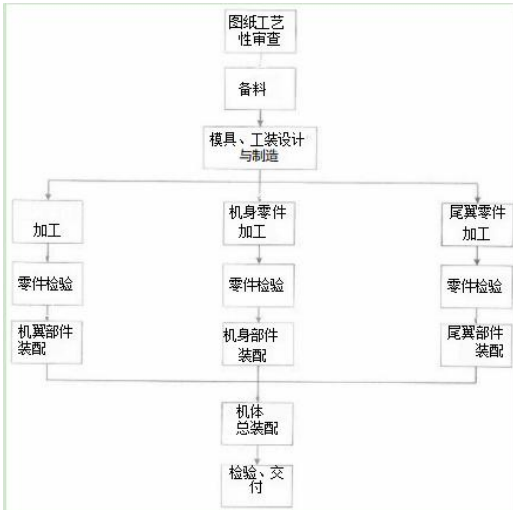
图 1.5.3.2-1 公司生产总流程
