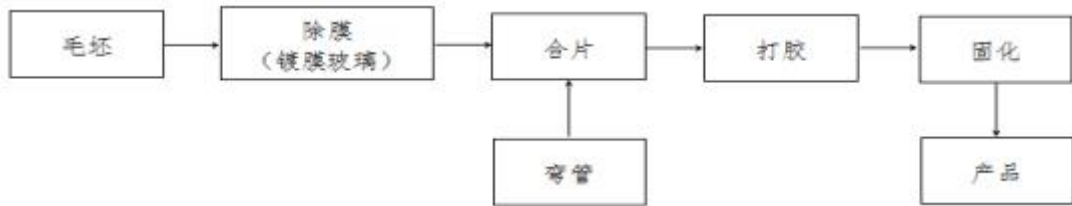
中空玻璃工艺流程图
